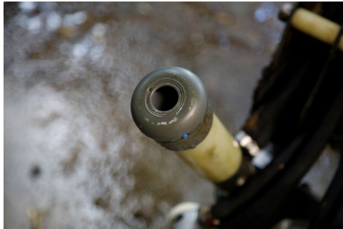
Foto 20: Vuilrestanten zichtbaar op en rond de melkbeker wijzen erop dat de reiniging onvoldoende is en/of de koeien onvoldoende proper zijn bij het betreden van de box.
