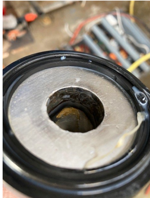
Foto 15: Vuilresten zichtbaar in melkleiding na openen van de koppeling.
