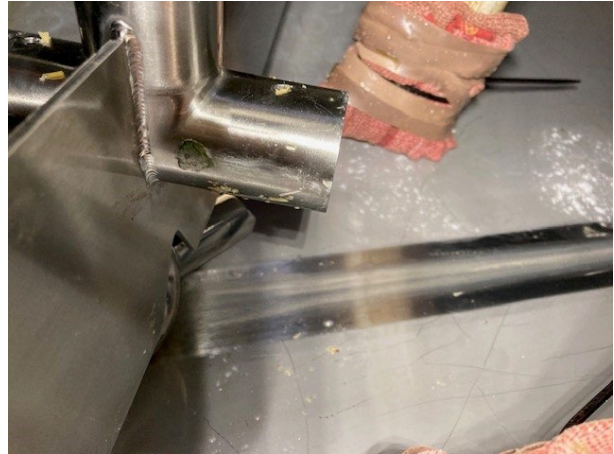
Foto 19: Melkrestanten en biofilm blijven achter in de melktank (een veeg is duidelijk zichtbaar na wrijving met een doek).
