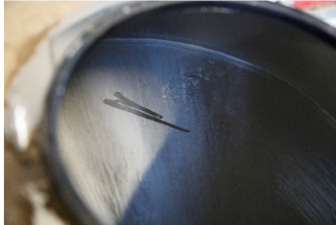
Foto 25: Biofilms detecteren met behulp van visuele inspectie.
